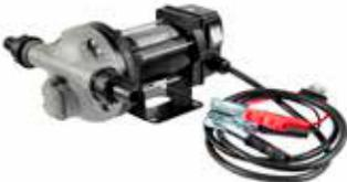
**Art. 098-6500-012** Bomba eléctrica de membrana para AdBlue® 12V 34 l/min longitud cable 4 m con pinzas
